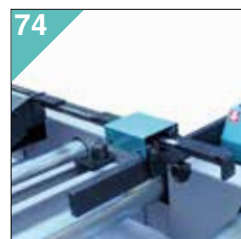
74 RL Digitální čtení s automatickým délkovým dorazem a s automatickými čidly pro zpomalení
