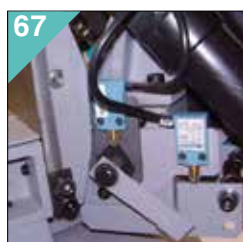
67 000910 RTD RTP Adaptér pro synchronizaci válečkového stolu s pohybem pilového ramene
