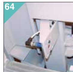
64 Laserová detekce pro automatický ořez materiálu
