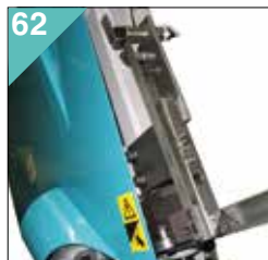
62 Zařízení pro kontrolu kolmé osy a přesnosti pilového pásu
