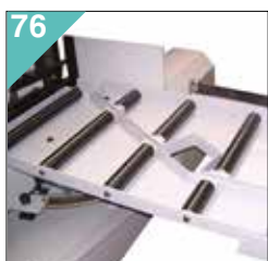
76 RAB61S H601 - H601 NC Spojovací prvek pro výstupní plochu.
