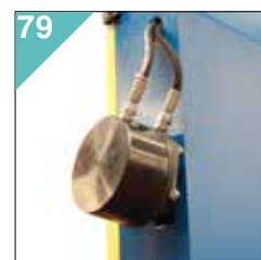
79 H 601 - H 700 - KS 702 KTECH 702 Hydraulické zařízení pro napínání pilového pásu
