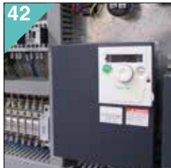
42 Převodník pro regulaci rychlosti pilového pásu
