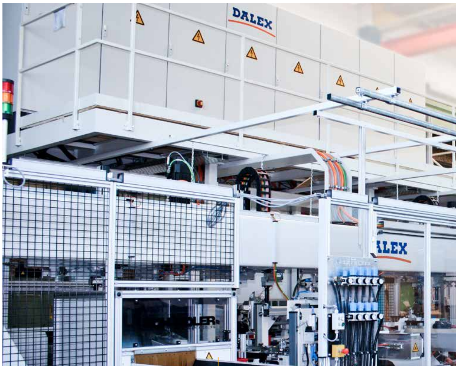
Lineární dopravní systém pro výrobu bočnic zásuvek kuchyňských linek
