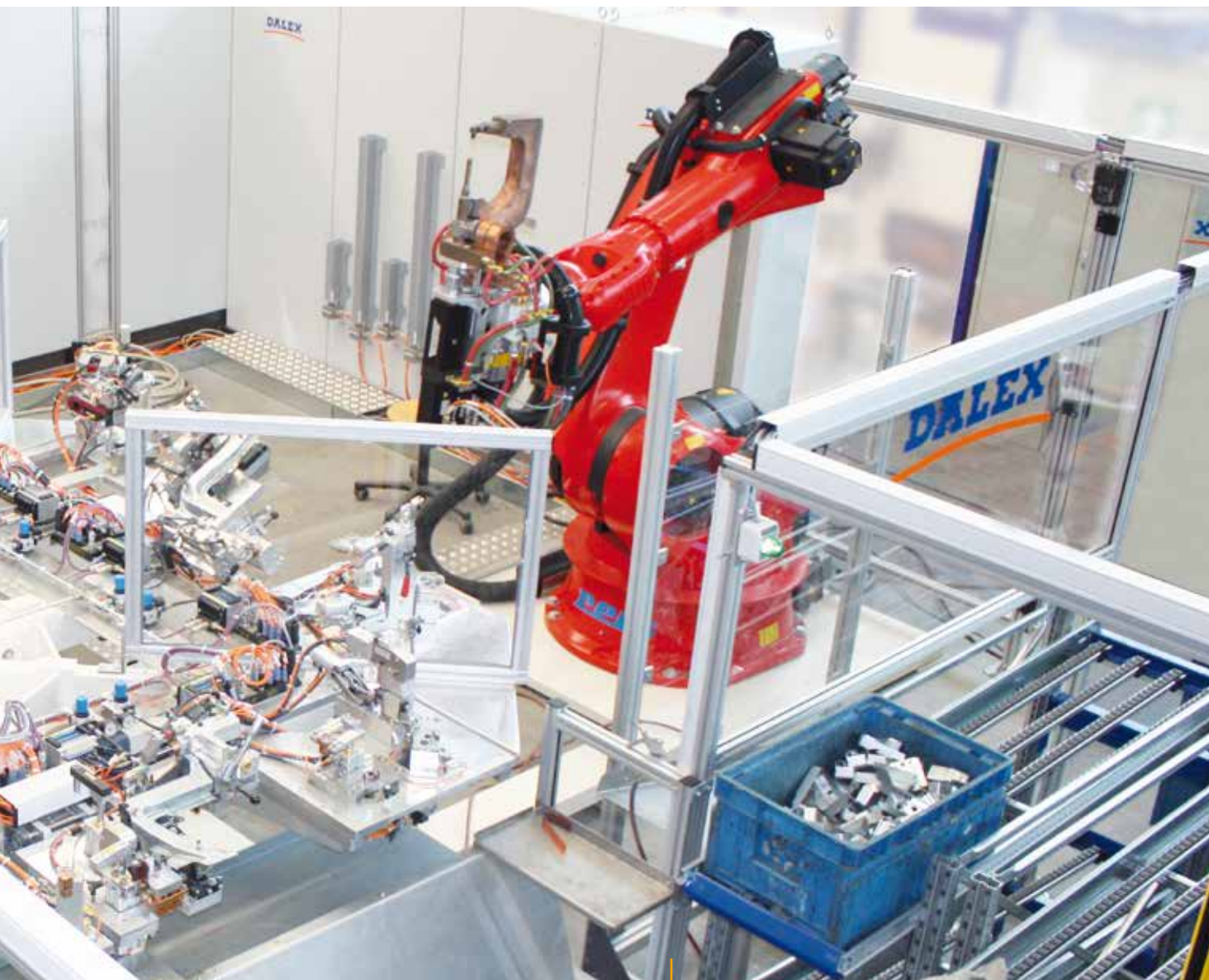
Otočný stůl se svařovacím robotem pro automobilový průmysl
