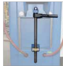
NASTAVOVACÍ ZARÍZENÍ s ráčnou k nastavení výšky ramene
