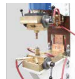
RYCHLOVÝMĚNNÝ SYSTÉM pro rychlou výměnu svařovacích přípravků
