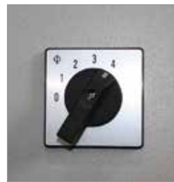
4STUPŇOVÝ PŘEPÍNAČ k ovládání výkonu svařování, umístěno v ovládací skříni
