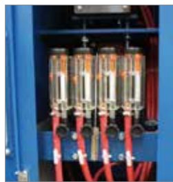
KONTROLA PRŮTOKU CHLADICÍ KAPALINY 4x
