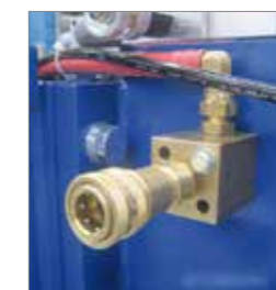
RYCHLOUPÍNÁNÍ přípojka chladicí kapaliny pro svařovací přípravky
