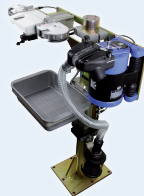
■ Variabilní umístění stanic pro frézování a výměnu čepiček
