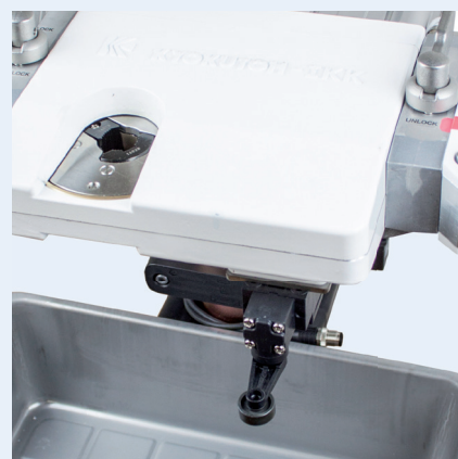
■ Kontrola přítomnosti čepičky pomocí koncového spínače
