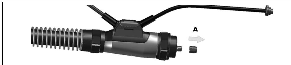
Obr. 5 Odstránenie prevlečnej matice
