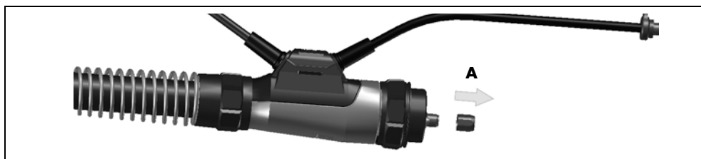
Rys. 5 Usunąć nakrętkę łączącą
