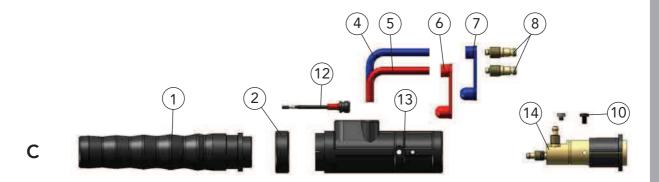
Für den Kompaktstecker DIX KCZME 330 N (Pos. C) benötigen Sie einen Power Pin / Power Pin-Set. Den für Ihren Drahtvorschub passenden Power Pin / Power Pin-Set finden Sie im Kapitel Werkzeuge und Zubehör oder fragen Sie Ihren DINSE-Fachberater.
